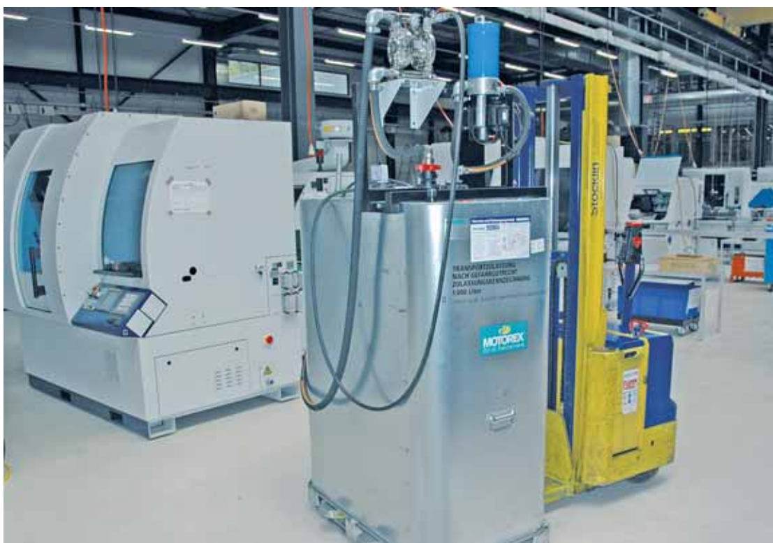
Numerosi serbatoi a doppia parete di questo tipo servono al riempimento e allo svuotamento delle macchine. Si spostano come dei pallet ed ognuno di essi è dotato di una pompa e di una unità di filtraggio.
