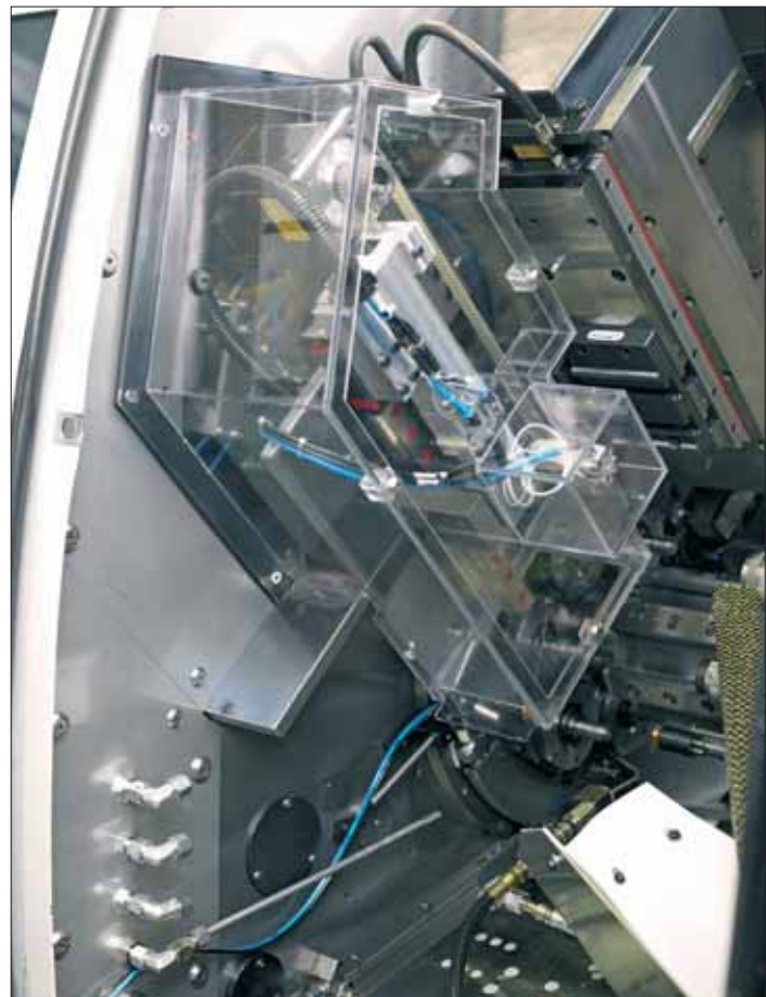
Arbeitsbereich mit dem Beschickungssystem. Jedes Projekt wird auf die Art der zu fertigenden Werkstücke abgestimmt. In diesem Beispiel erfolgt die Aufnahme in die Gegenspindel durch eine Greiferzange.
