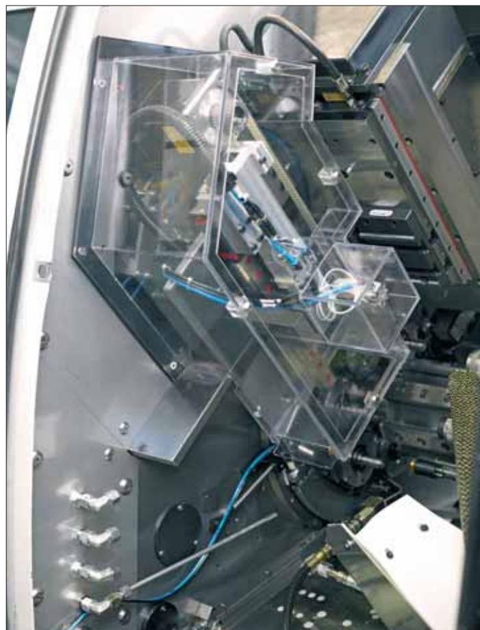
Zona de mecanizado que muestra el sistema de carga. Cada proyecto es específico en función de las piezas que deban realizarse. En este ejemplo la colocación de la pieza en el contrahusillo se lleva a cabo con una pinza de manipulación.
