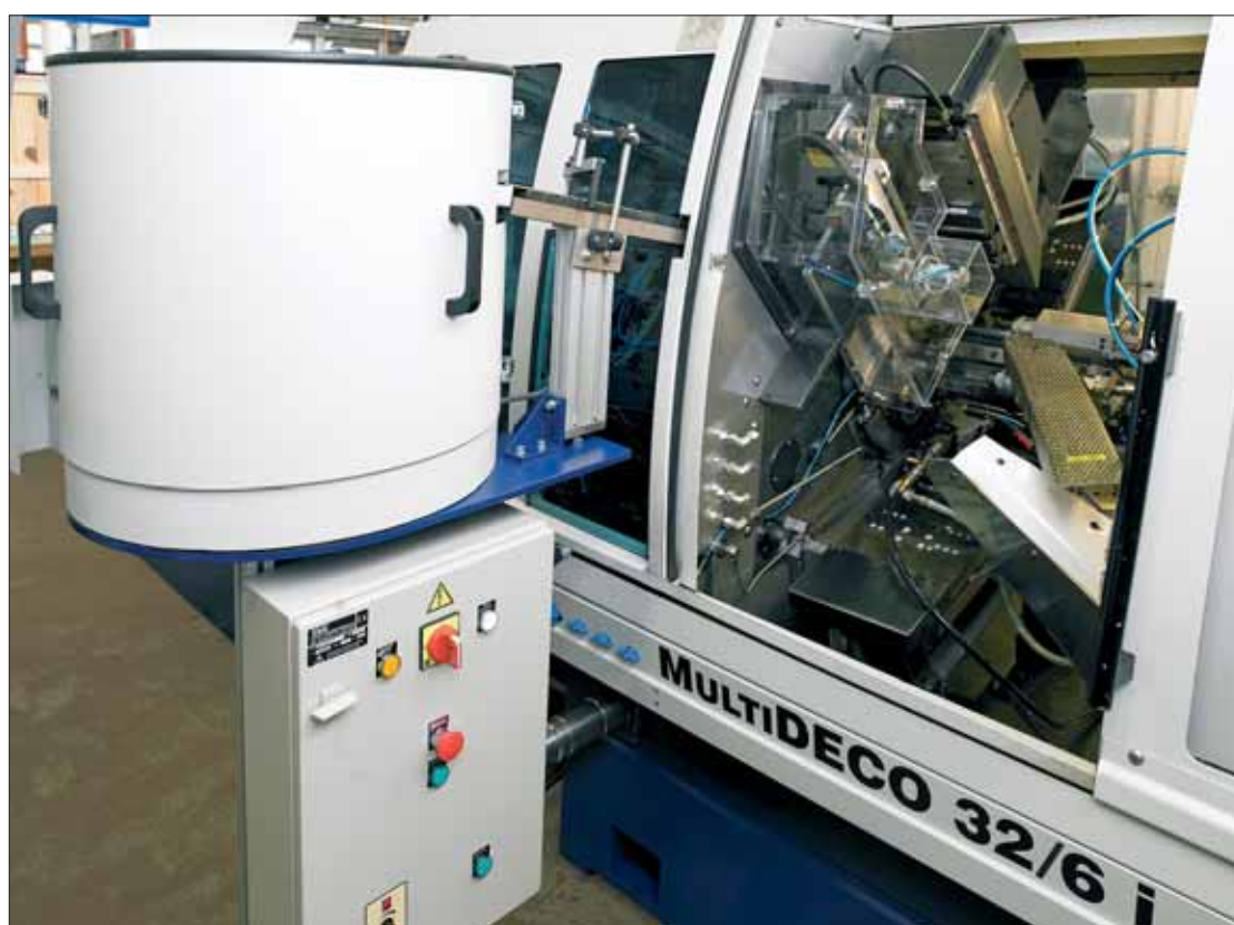
Système d'alimentation «par tobogan» associé à un bol vibrant.
