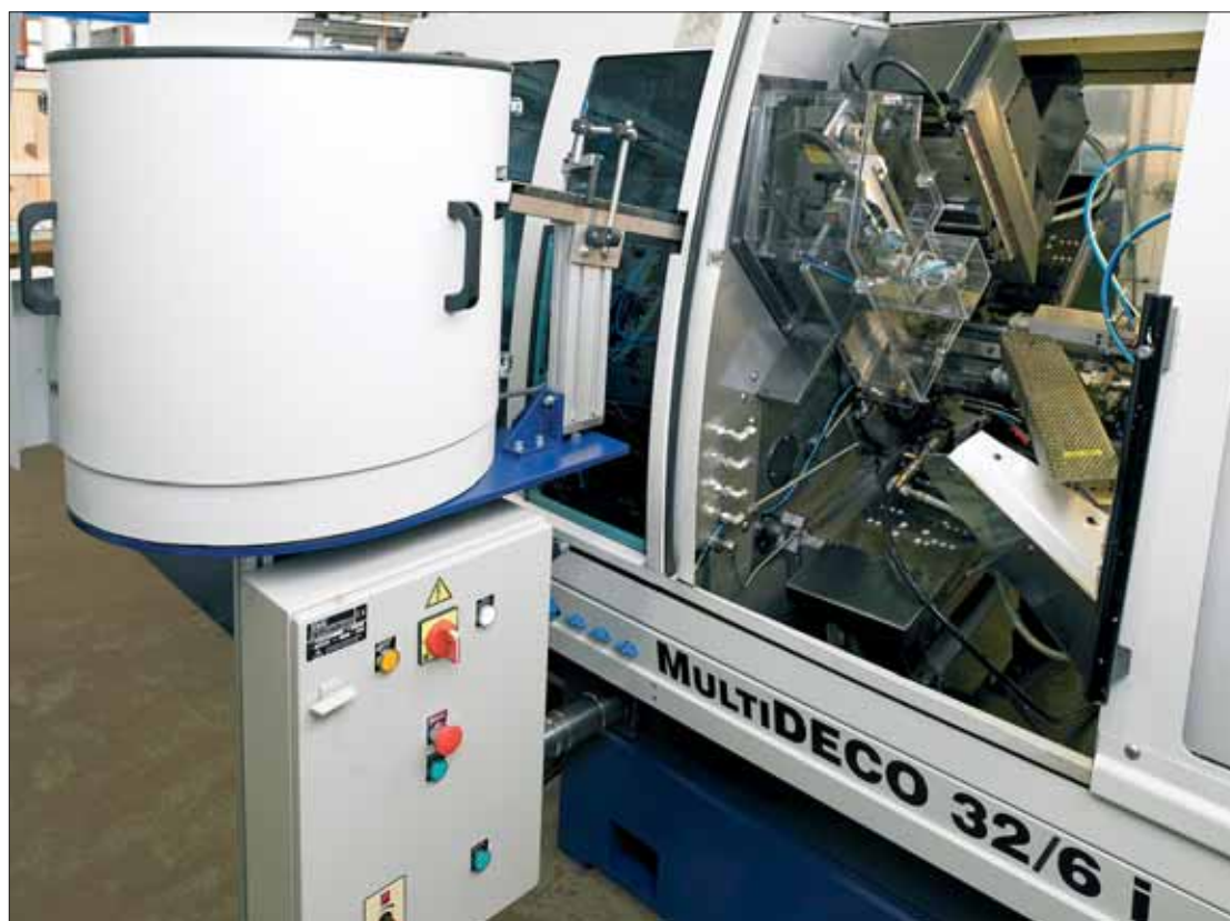
Sistema di alimentazione "tramite toboga" associato ad una coppa vibrante.
