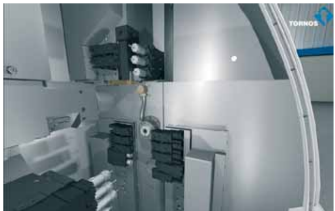
Blick in den Arbeitsbereich von DECO 13a.
