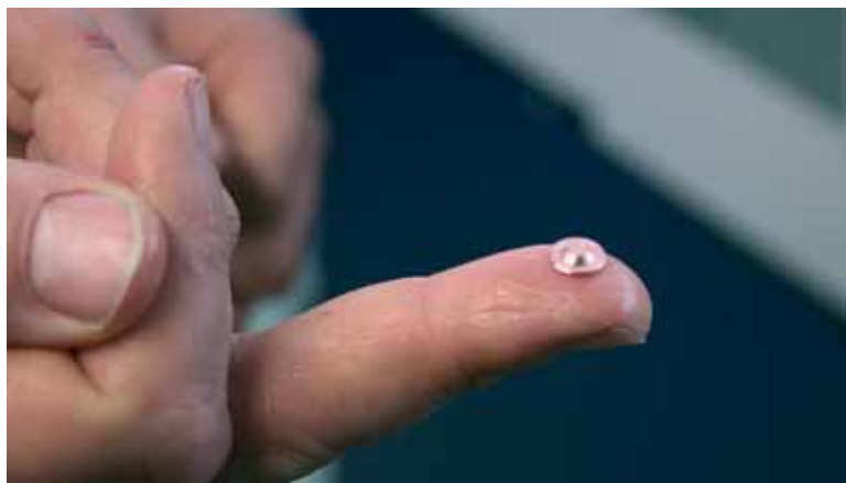
Auf der Delta 20/5 gefertigtes Drehteil.
