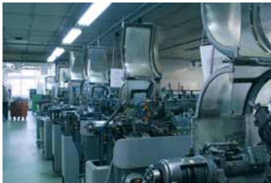
Die kurvenscheiben-gesteuerten Drehautomaten sind noch gut ausgelastet.
