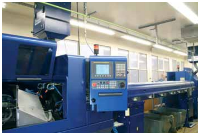
Una de las Micro 7 con su cargador de barras en un entorno claro y limpio.
