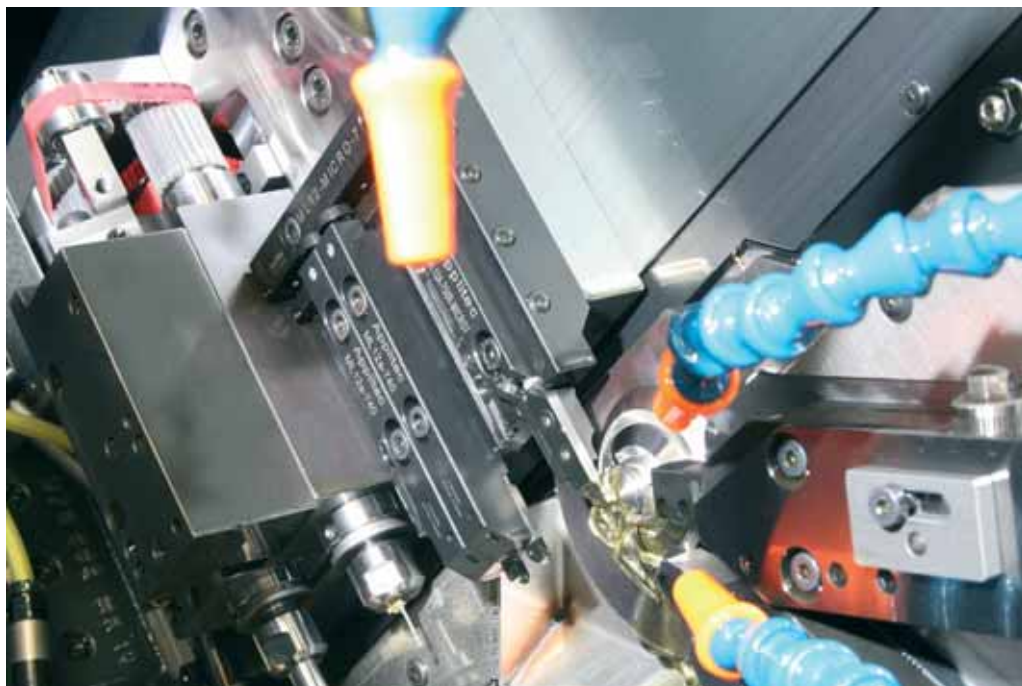
Uno sguardo sul sistema di utensileria Modu-Line installato su una delle Micro 7.
