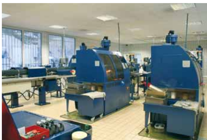
Una delle sale macchine con dei torni automatici DECO 2000. Altro locale in cui la pulizia é rigorosa.
