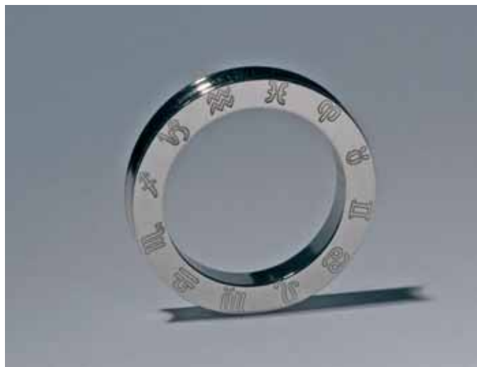
...y el anillo terminado con los signos del zodiaco mecanizado con la Sigma 20.
