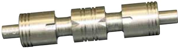
Pieza típica mecanizada por MMT. El número que figura a la izquierda en la parte cilíndrica se ha grabado con el torno durante las operaciones de mecanizado.
