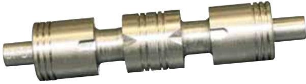
Pièce typique usinée par MMT. Le numéro à gauche sur la partie cylindrique est gravé sur le tour pendant les opérations d'usinage.
