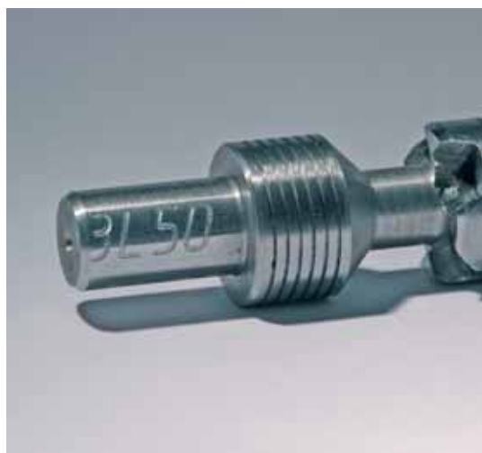
Dettaglio di un'iscrizione programmata con Millwriter ed incisa sul tornio.
