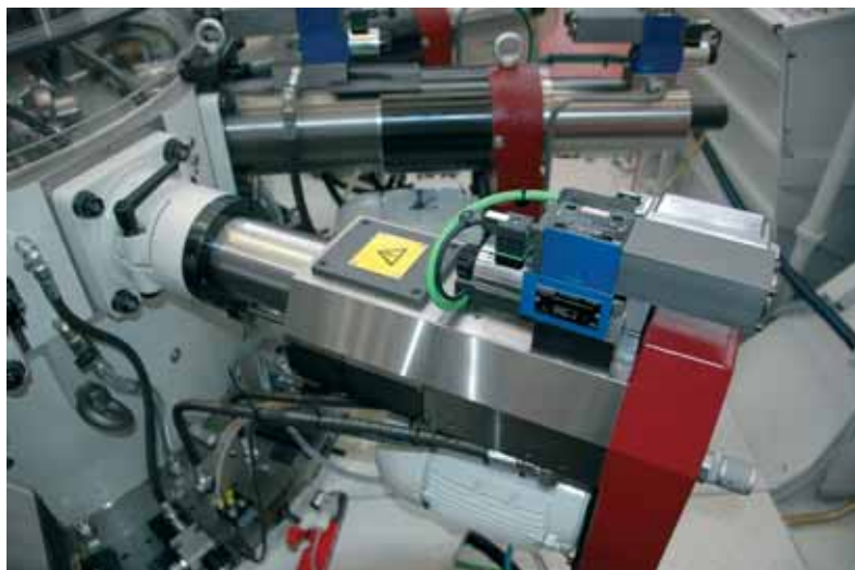
Bis zu 16 dieser elektro-hydraulischen Bearbeitungsstationen sind bei den Rundtaktmaschinen der K.R. Pfiffner AG im Einsatz. Die Rotation wird elektrisch generiert - die Längs- und Querbewegungen hingegen hydraulisch.
