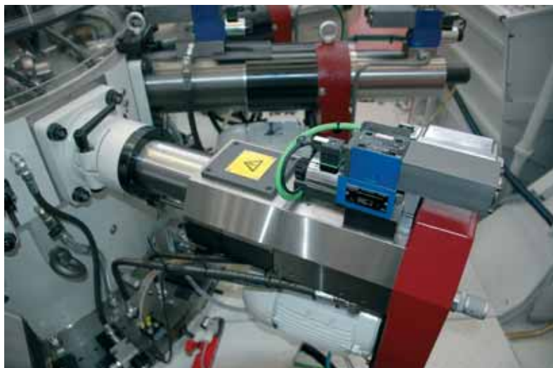
Le macchine a transfert rotativo di K.R. Pfiffner AG, come quella raffigurata, dispongono sino a 16 postazioni di lavorazione elettro-idrauliche. La rotazione avviene tramite dei motori elettrici, i movimenti di traslazione longitudinale e trasversale tramite sistema idraulico.
