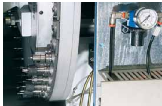
Das Werkzeugmagazin der Gegenspindel hat ein Fassungsvermögen von 48 Werkzeugen.
