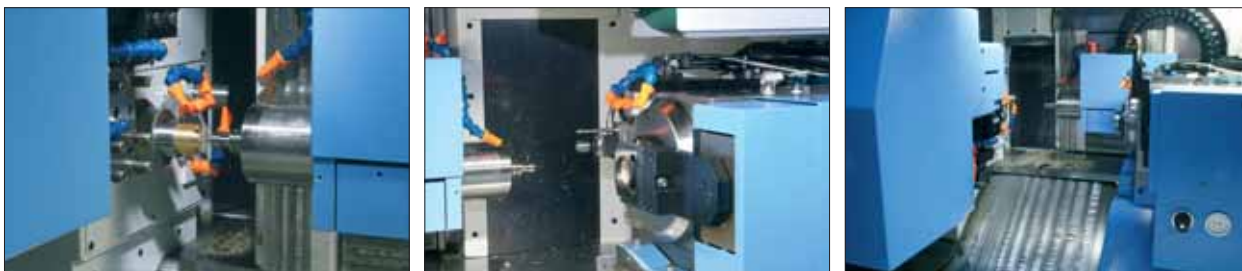
Vistazo del husillo principal: la máquina está preparada para mecanizar la cara uno de una nueva platina directamente en la barra. El contrahusillo espera una platina para mecanizarla en la cara dos...que va a buscar directamente en el husillo principal.
