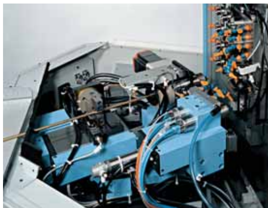
Concebido para asegurar fresados de precisión tanto en aceros tenaces como en metales nobles, la máquina FB 1005 está dotada de una corredera X guiada sobre railes pretensados y movida por husillos de bolas. La corredera aguanta el eje vertical Y formado por un prisma macizo de fundición sobre el que se desliza una manga rectangular. Guiada sobre 4 railes pretensados, la manga también se mueve gracias a un husillo de bolas y permite montar un bloque provisto de husillos frontales, laterales y verticales.
