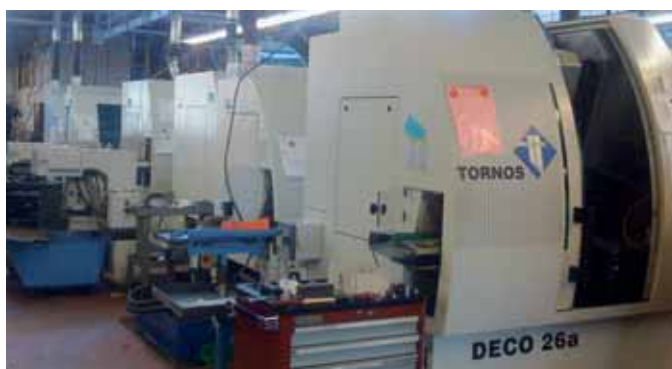
Veduta parziale dell'officina Décovi, in cui si trovano le macchine DECO che sono tutte collegate al sistema centralizzato per l'evacuazione delle nebbie d'olio.
