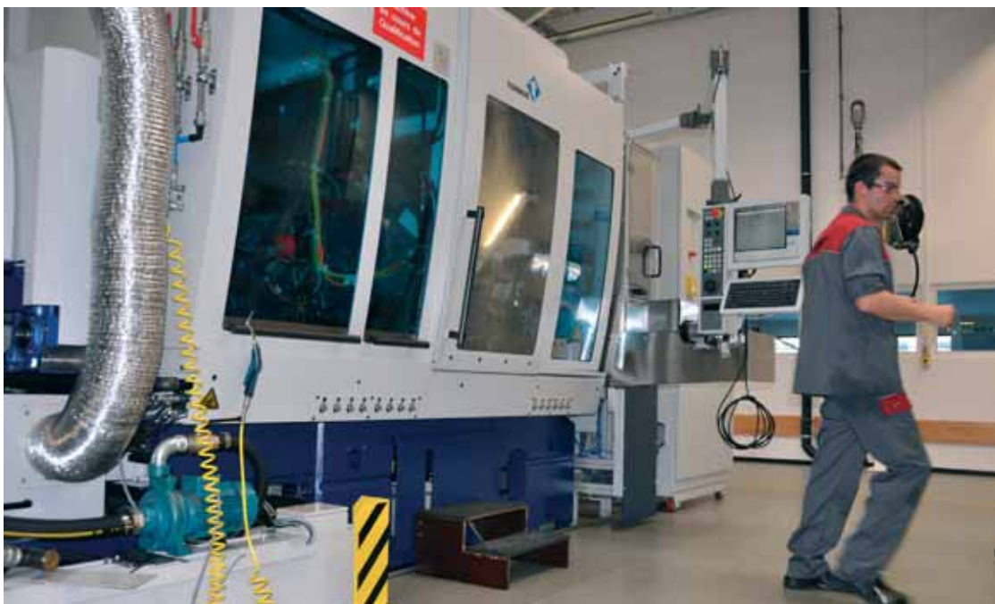
Rund 12 Tonnen bringt die leistungsstarke Tornos MultiAlpha 8x20 auf die Waage – sie kann auf Wunsch vielseitig ausgebaut werden und so jede erdenkliche Bearbeitungsoperation ausführen. Dabei ist auch das flexible IT-Programmiersystem äusserst hilfreich.
