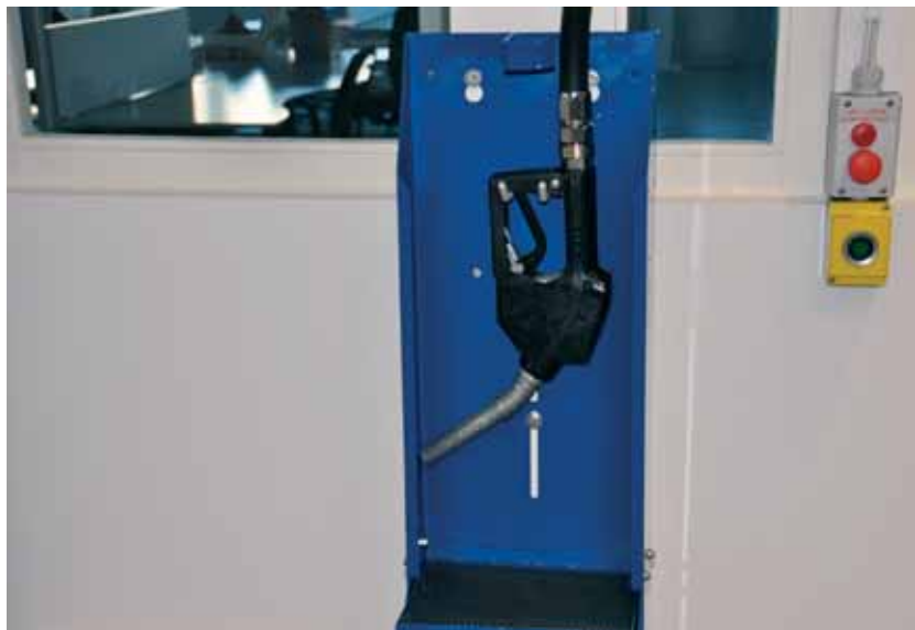
Natürlich werden bei Stryker Spine die Bearbeitungsfluids zentral gelagert und über Zapfpistolen in unmittelbarer Nähe zum Bearbeitungscenter ausgegeben. Bei jeder Maschine wird der Zustand des Schneidools regelmässig überwacht.
