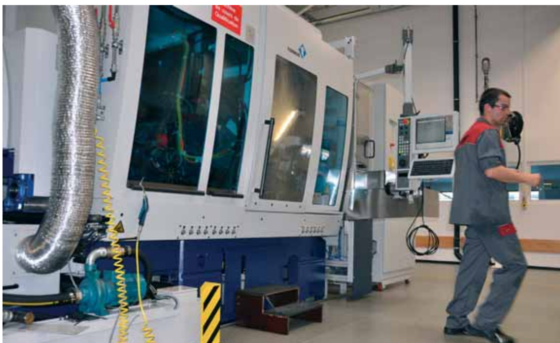
El potente MultiAlpha 8x20 de Tornos pesa aprox. 12 toneladas; puede desmontarse como se desee para poder ejecutar cualquier tipo de mecanizado que se imagine. También resulta una ayuda fundamental el flexible sistema de programación IT.
