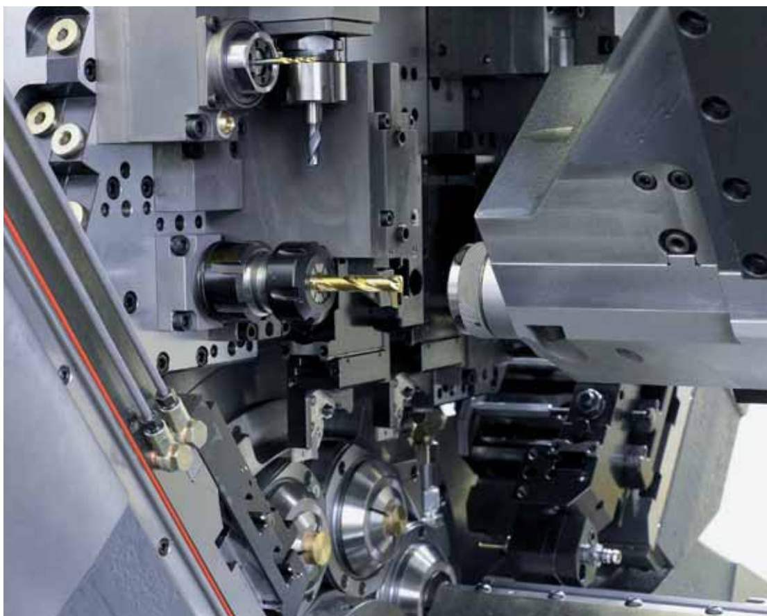
I due contromandri ognuno dei quali montato su un asse, possono afferrare i particolari dopo la trancitura e lavorarli sul lato posteriore (tornitura, foratura, fresatura, ecc.).
