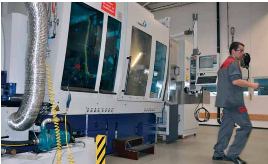
Il tornio Tornos MultiAlpha 8x20 pesa circa 12 tonnellate, può essere corredato con varie opzioni per eseguire tutte le immaginabili operazioni ed è inoltre dotato di un sistema di programmazione informatizzato polivalente.
