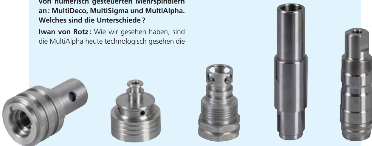
Diesem Werkstücktyp stehen nun alle Türen eines Mehrspindlers offen. Sogar Gewindewirbeln ist möglich!
