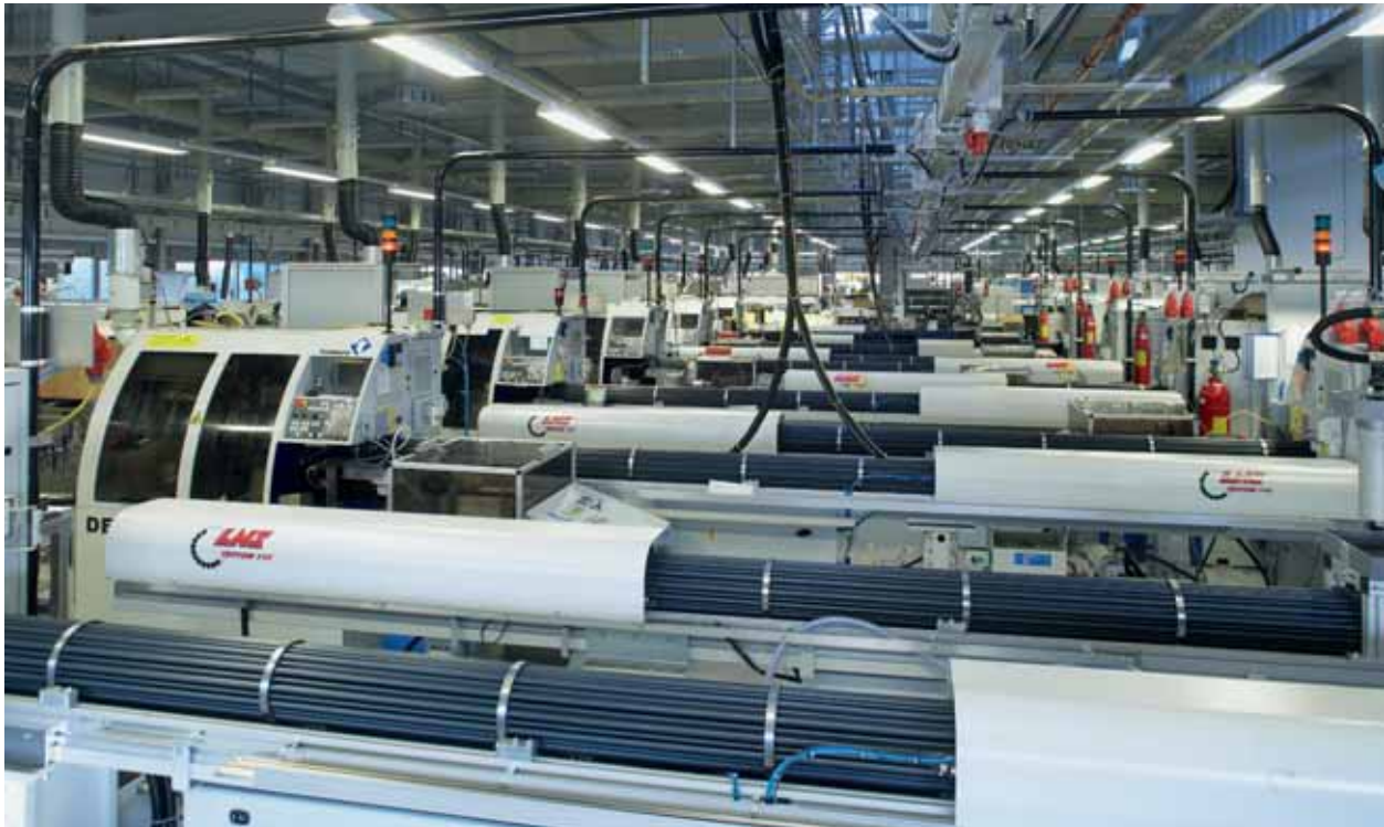
Im hochmodernen Maschinenpark von Prefag dominieren beim Drehen eindeutig die CNC Einspindelrehautomaten von Tornos.
