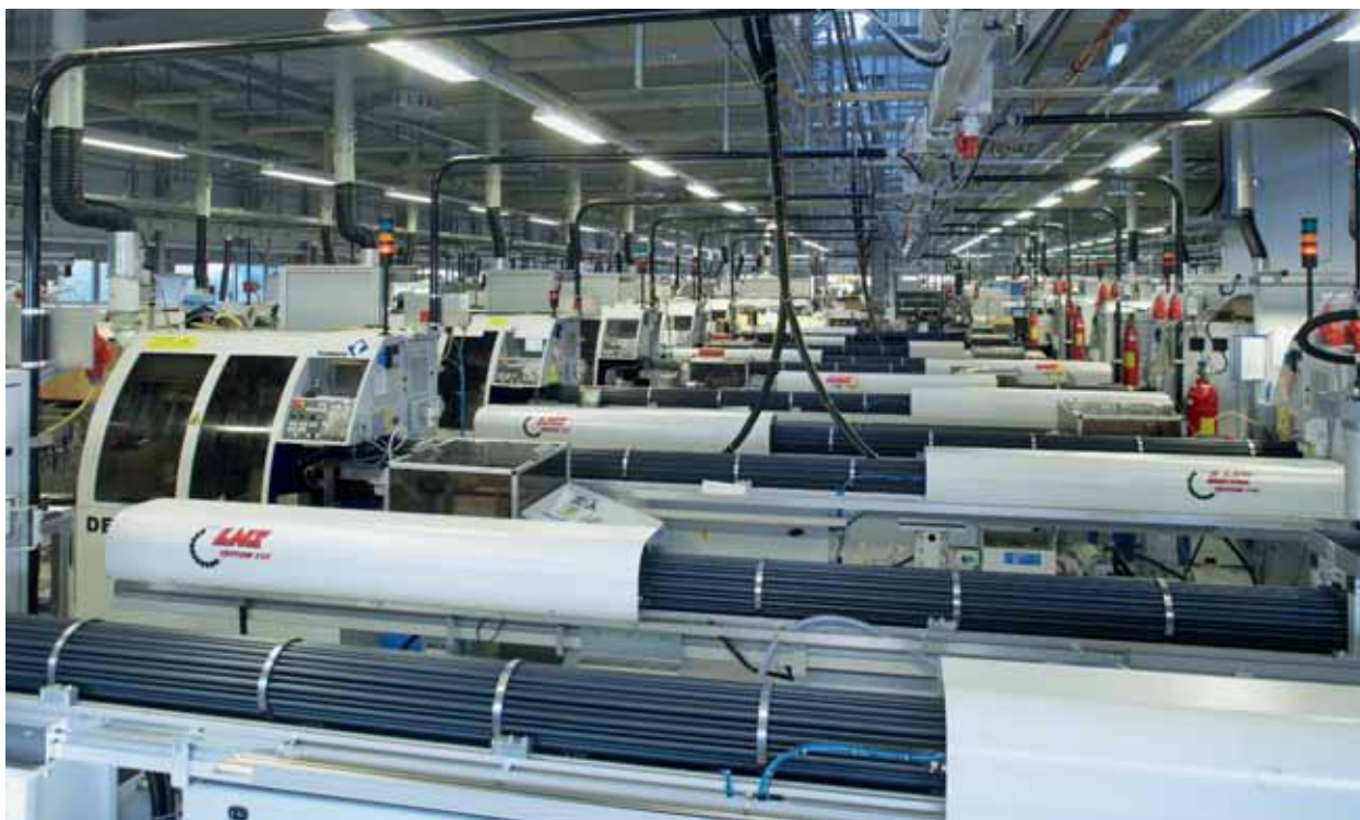
En la sección de torneado del ultramoderno parque de máquinas de Prefag ocupan un lugar predominante los tornos monohusillo CNC de Tornos.
