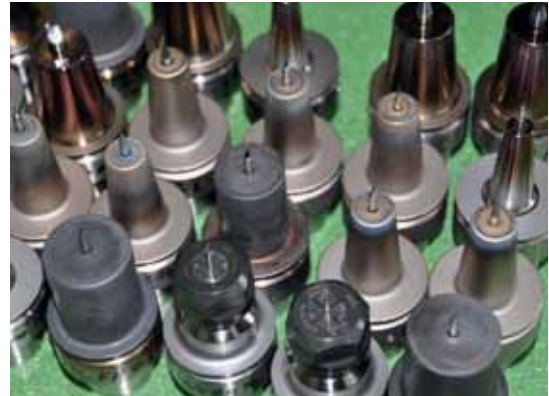
En los modernos centros de mecanizado se utilizan las más variadas herramientas para las distintas operaciones. El cambio se realiza de forma totalmente automática.
