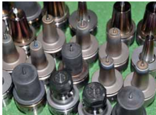
I moderni centri di lavorazione, impiegano gli utensili più disparati per ogni operazione. Il cambio dell'utensile è automatico.
