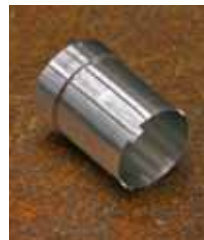
Componente di commutatore (pezzo appena uscito dalla macchina)
