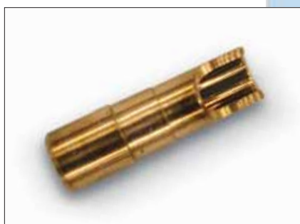
La pièce réelle correspondant au modèle ci-dessus, programmée dans PartMaker et usinée sur la Tornos Deco 7a de QA Technology
