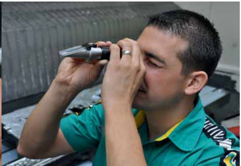
Das Ermitteln der Konzentration (Anteil KSS-Konzentrat in % und Wasser) kann mit einem optischen Refraktometer oder einem elektronischen Messgerät einfach und präzise ermittelt und in das Maschinenlogbuch eingetragen werden.
