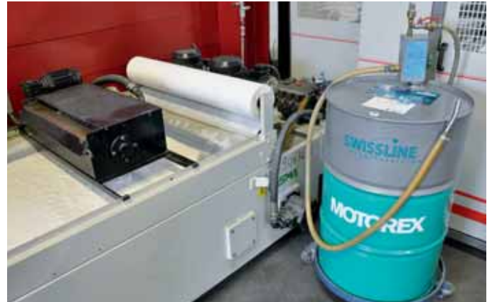
Con el absorbedor de aceite de banda, se «evacua» el aceite de fuga y, a través del filtro de banda, se extraen las virutas o partículas de metal más finas. El compacto mezclador de lubricante refrigerante aparece bien visible en el bidón móvil de Motorex.
