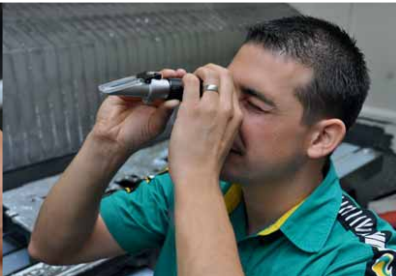
La concentración (porción de lubricante refrigerante en % y agua) se calcula de forma precisa y sencilla con un refractómetro óptico o un medidor electrónico. Los resultados se introducen en el libro de registros de la máquina.
