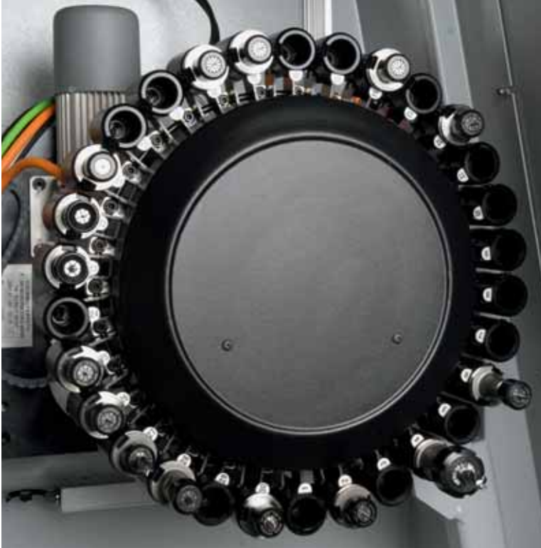
Werkzeugwechsler mit 30 Positionen ISO 25 vom Typ „Random“
