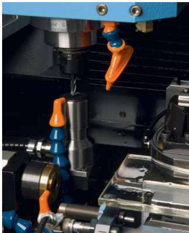
Sistema integrato di prerogolazione degli utensili
