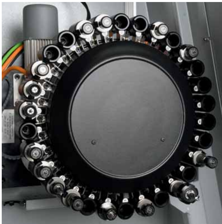
Cambiatore di utensili 30 posizioni ISO 25 tipo «random»
