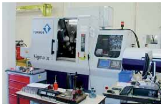
Die Maschine Sigma 32 von Tornos ist permanent mit den Mess- und Kontrollvorrichtungen verbunden, damit sämtliche Bearbeitungen im Detail untersucht werden können.
