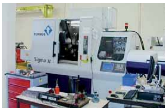
La macchina Sigma 32 di Tornos è collegata in permanenza ai dispositivi di misura e di controllo, in tal modo tutte le operazioni sono sezionate nel dettaglio.
