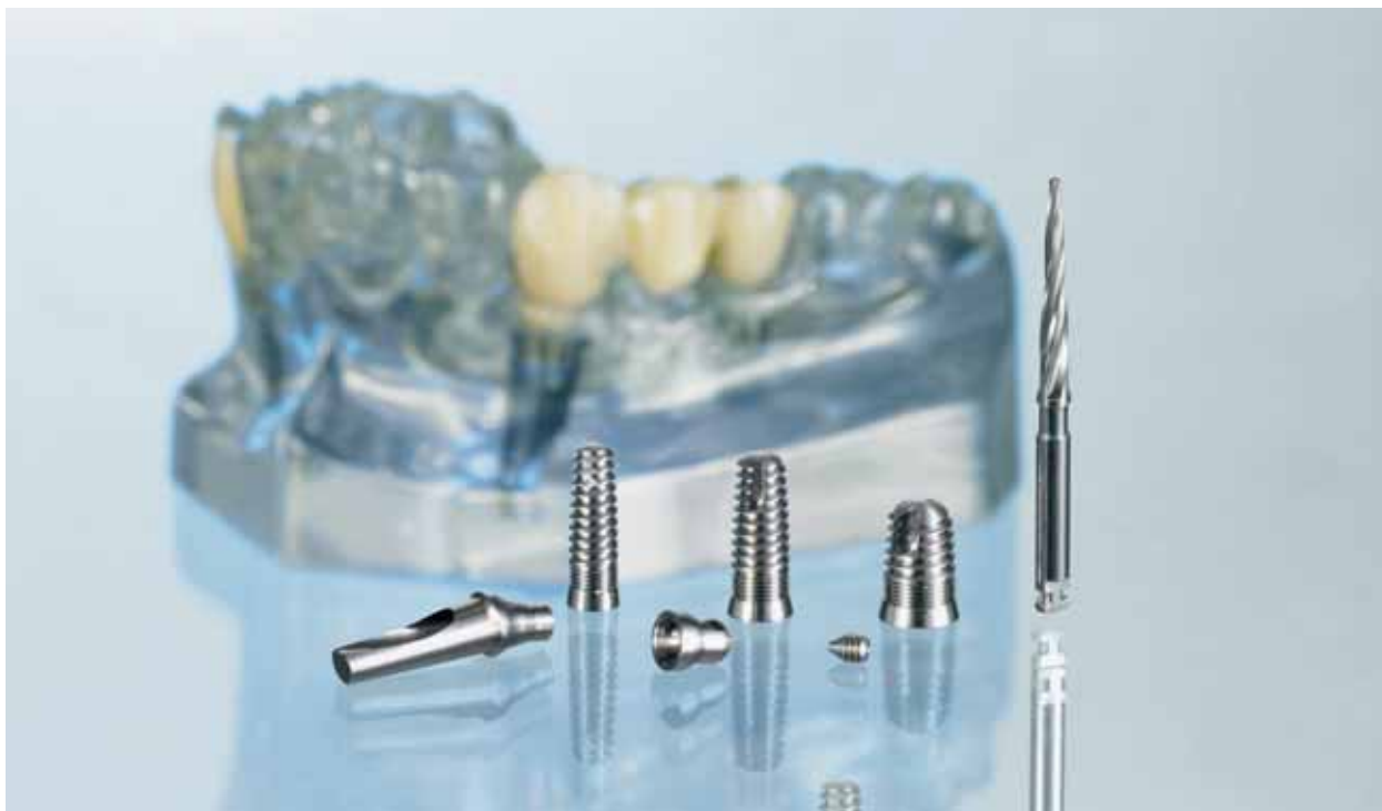
Piezas mecánico-dentales de UND empezando por la izquierda: perno y tornillo para implante dental de titanio 6 V, anclajes de rosca para implantes dentales de acero inoxidable 316 L y un taladro fabricado de acero inoxidable 420 F.
