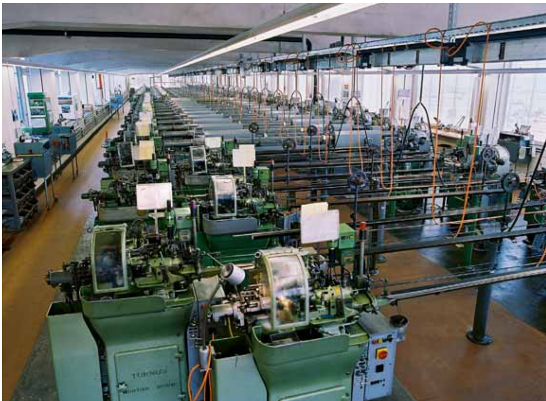
Der Maschinenpark des Unternehmens mit kurvengesteuerten Maschinen befindet sich in perfektem Betriebszustand, dennoch denken die Geschäftsführer an die Zukunft des Unternehmens. Letztere werden nach und nach durch Maschinen vom Typ Delta ersetzt.
