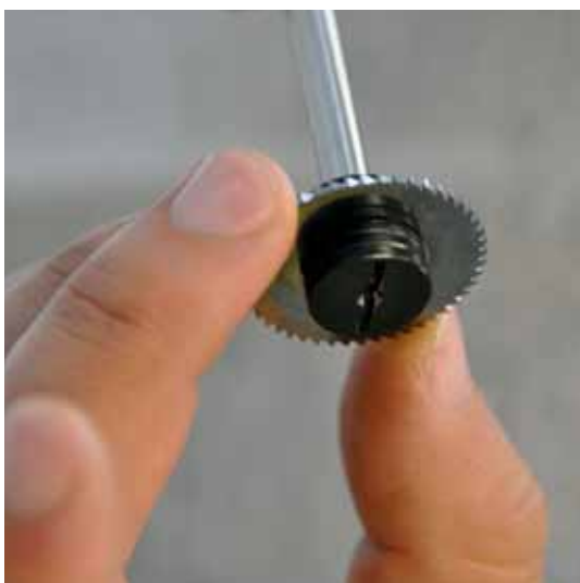
Die Fräsresultate mit Motorex Ortho NF-X in den Gabeln der Fasszangen lassen sich sehen – ebenso die Werkzeugstandzeit des HSS-Fräasers.
