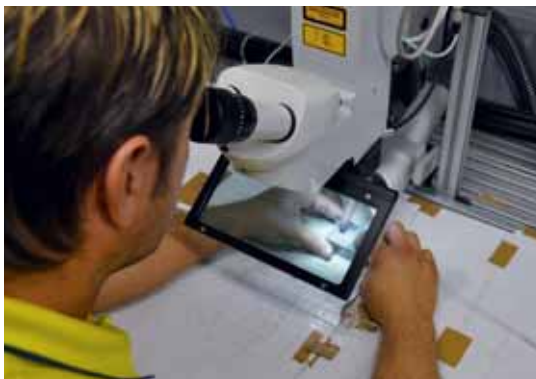
Las piezas de las pinzas de agarre están unidas mediante articulaciones con un empalme. Éste está soldado con láser con una cuerda sometida a una ampliación óptica.
