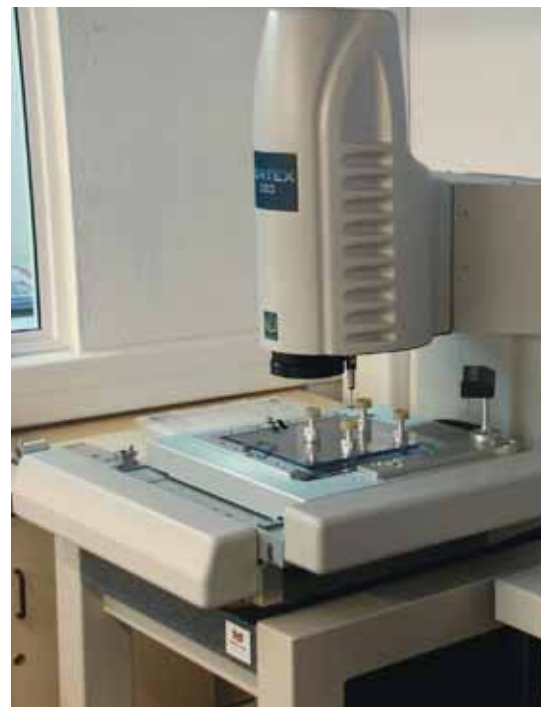
L'azienda dispone di una camera grigia, di un sistema di visione e di tastatura 3D.
