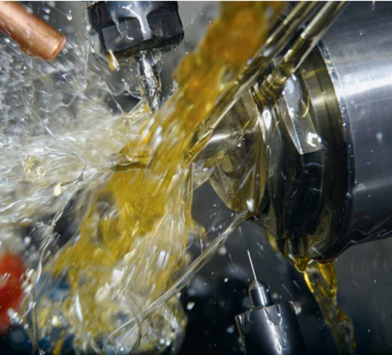
Neuentwicklung aus dem Hause Blaser – chlorfreies Schneidöl für die Tantalzerspannung.
