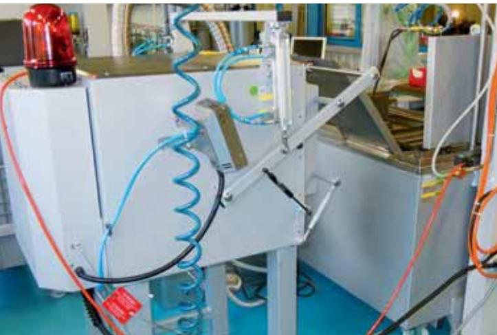
Härteanlage für die reproducible Fertigung von Spannzangen in Kleinserien.
