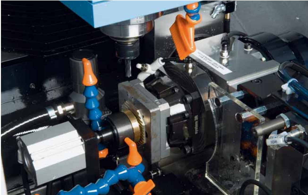
Teilapparat 4. Achse mit vertikaler/horizontaler Schwenkung: eine weitere Besonderheit im Bereich Automatisierung bei Almac.
