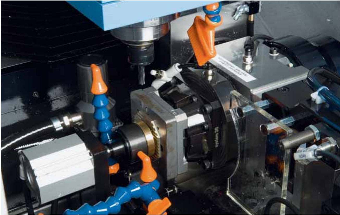
Diviseur 4 e axe avec bascule verticale/horizontale: une autre particularité d'automatisation d'Almac.
