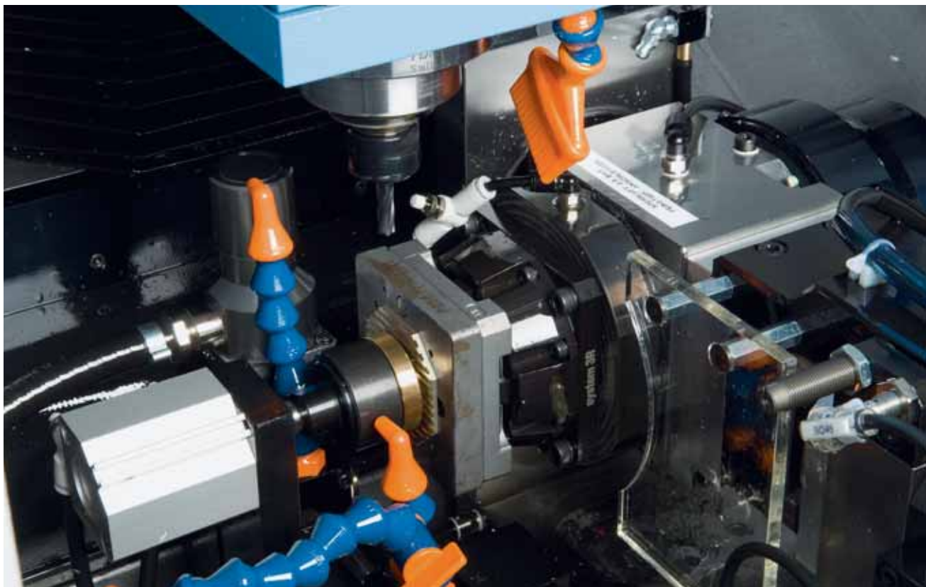
Divisore quarto asse con bascula verticale/orizzontale: un'ulteriore particolarità di automatizzazione di Almac.
