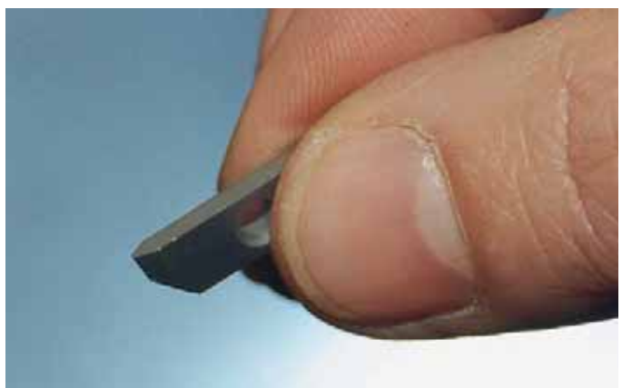
Gianni Tescaro muestra una herramienta utilizada en una prueba con valores de corte modificados. La vida útil de la herramienta se mantuvo elevada gracias a las reservas de Ortho NF-X.
