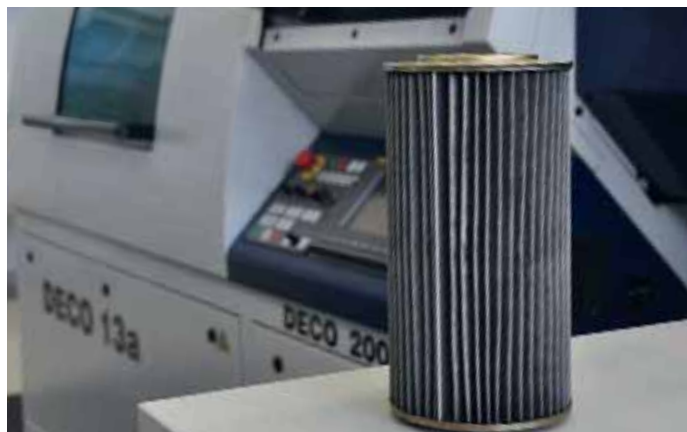
Con la taladrina Ortho NF-X con la viscosidad Iso VG 15, el calor se evacua de forma eficaz y es posible filtrar sin problemas las partículas de abrasión más finas del titanio. El fluido no se adhiere a los poros de filtrado.
