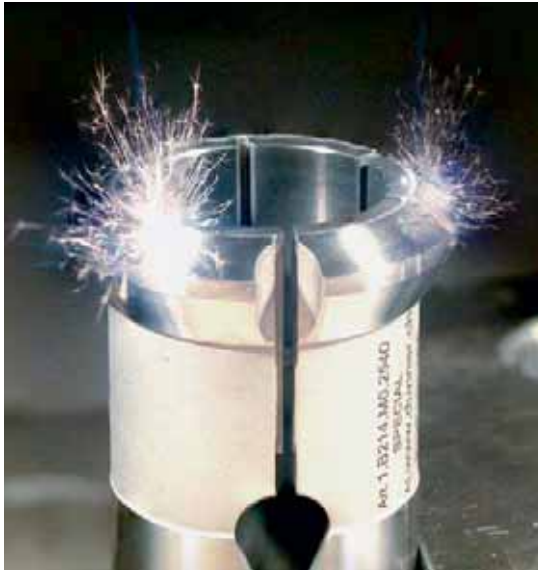
Die Referenzen werden mittels Laser geprägt.
