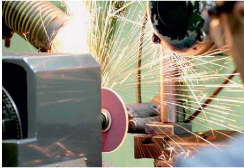
Operaciones de rectificado en pinzas especiales.
