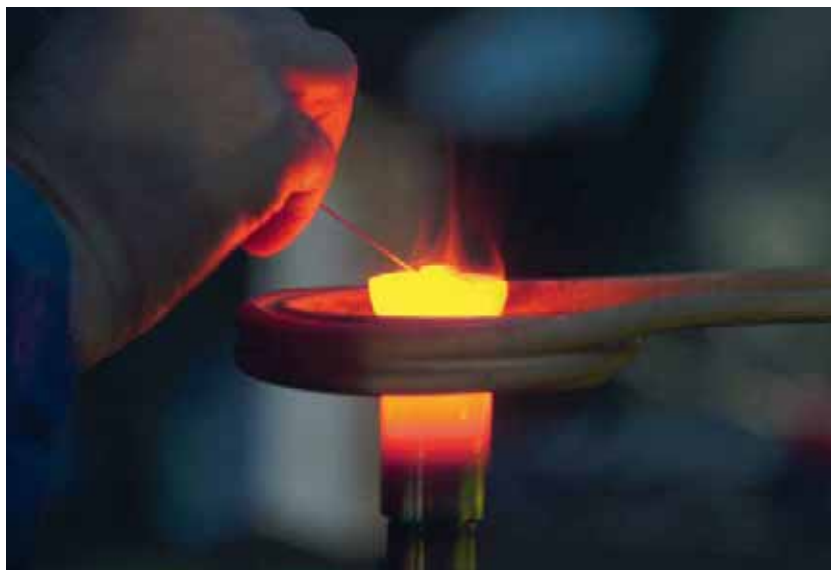
Soldadura de metal duro en el cañón.
