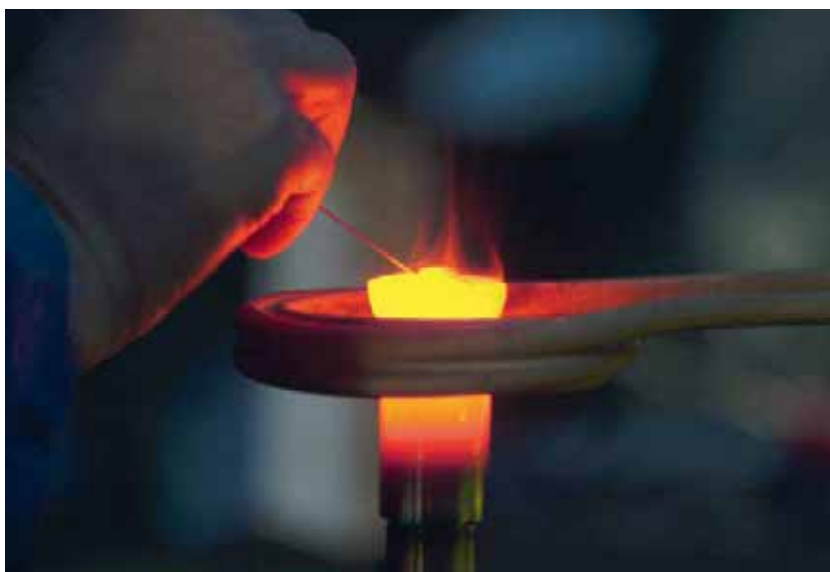
Saldatura del metallo duro nella bussola.
