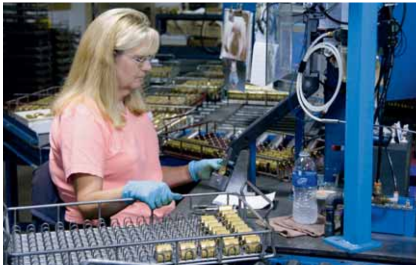
Esta es una de las máquinas de montaje personalizadas utilizadas para montar las cerraduras WB. Aunque siempre buscamos automatizar en la medida de lo posible, la empresa también cree que el elemento humano es crucial en sus operaciones.
