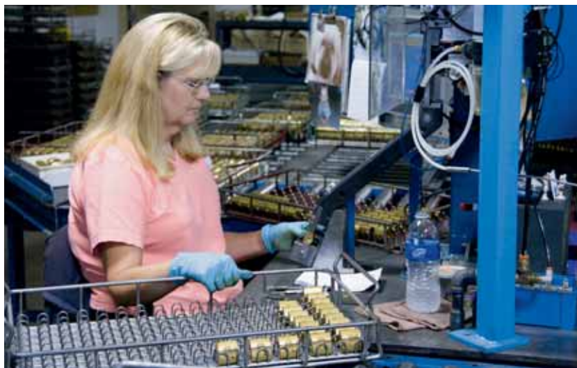
Una delle macchine «fatta in casa» utilizzate per assemblare i catenacci WB. La società è sempre propensa ad automatizzare quando essa presenta un'utilità pratica. Non di meno, essa è altresì convinta che l'elemento umano sia indispensabile al suo buon funzionamento.
