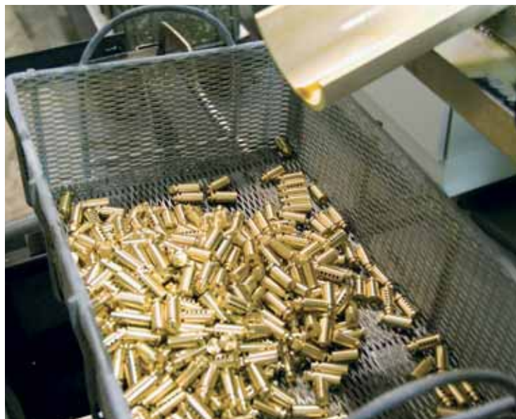
A destra: uno dei due contro-mandrini montati su portico presenti sulla macchina multimandrini a comando numerico di marca Tornos acquistata dalla WB. A sinistra il toboga che scarica i particolari. Grazie alla capacità di lavorazione 2 x 4 della macchina, esso trasporta due pezzi finiti per ciclo.
